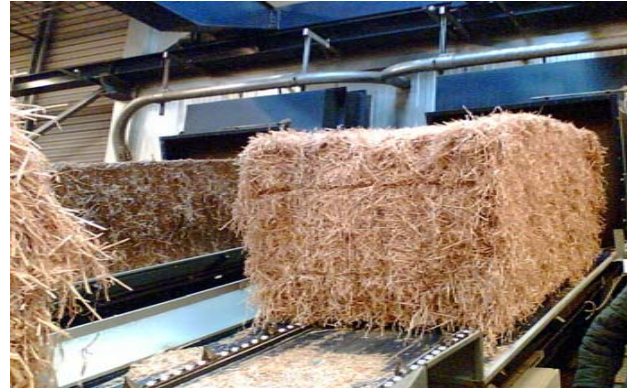
Figura 14: Ingresso linea alimentazione
